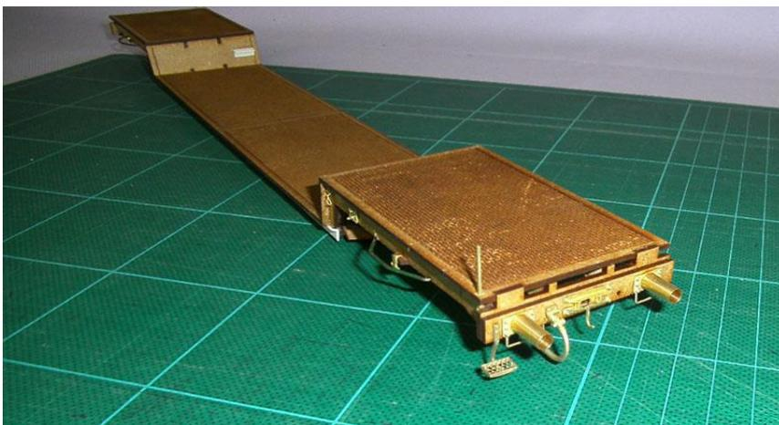
Der Oberbau wird mit Sprühspachtel behandelt und grundiert,
