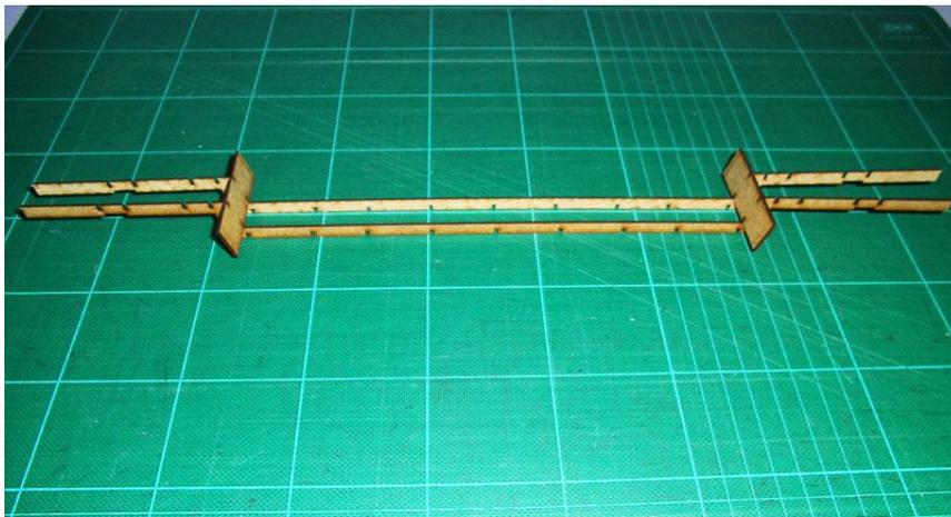
Die Hilfsquerträger für die Drehgestell Bühne werden ebenfalls auf die Hauptlängsträger geklippt.
